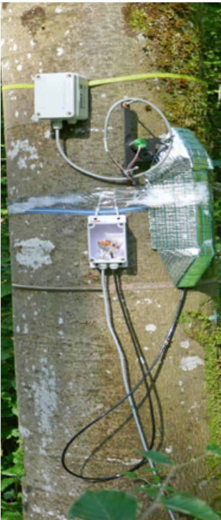
Gespickt mit Messgeräten: Datenlogger, Saftflusssensoren (Mitte) und Banddendrometer liefern detaillierte Daten. Foto: A. von Ascheraden
